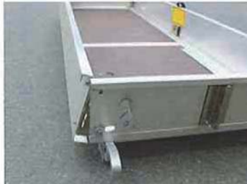
スツパー固定金具を床板に合す スツパー固定金具で固定
