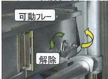
スツパー固定金具を床板に合す スツパー固定金具で固定
