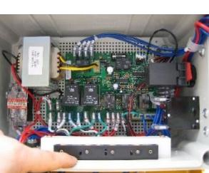
単3アルカリ電池 (LR6 1.5V) が8本収納されていますので、全て新しい物と交換し元の場所に戻してコントロールボックスのフタを閉め下さい。
