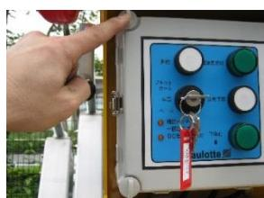
下部コントロールボックス左の上下にある2本のプラスチック製の止め具を左に回して緩めて下さい。(抜き取る必要はありません)
