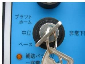
下部コントロールボックスにあるキーシリンダーの鍵をベース側（下側）に切り替えて下さい。
