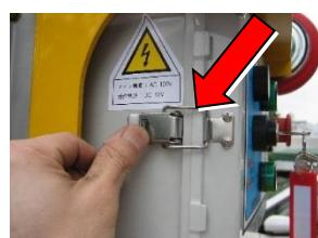
コントロールボックスの左側面にあるロック金具を解除して下さい。
