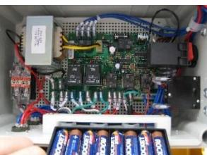
コントロールボックスの中央下部にバッテリーを収納してある黒いプラスチック製のボックスがありますので、これを引き出して下さい。裏側にコードが繋がっていますので、必要以上に引っ張らないで下さい。
