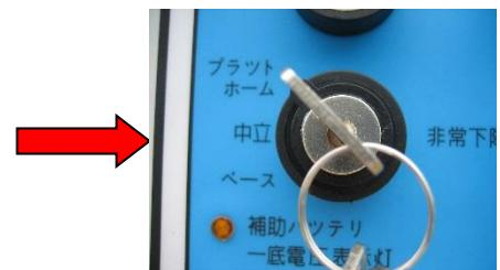
次にキーシリンダーの上にある開始ボタンを押すと 電源表示灯（緑色）が点灯し通電が確認できます。
