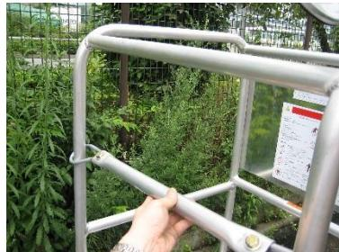
作業カゴの中段にある落下防止バーを持ち上げ、作業台に乗り込みます。
