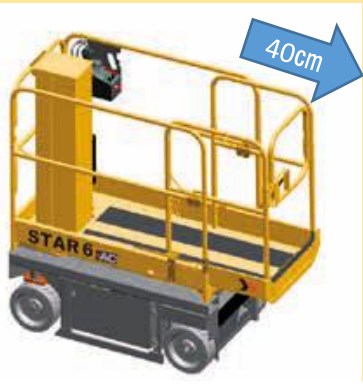
メーカーオプションで作業床張出装置（40cm）を追加する事も可能（STAR6のみ）
