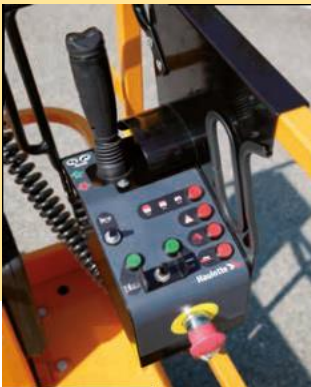
ジョイスティックを採用したバスケット内の操作パネル（手前は緊急停止ボタン）
