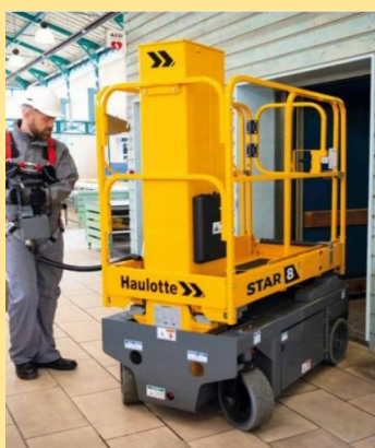
全機種がバスケット内のコントロールBOXの取外しが可能なので狭い場所では作業車の外から操作が可能（STAR10を除く）
