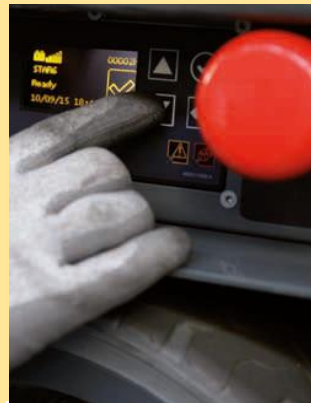
下部操作パネルのマルチディスプレイと緊急停止ボタン。下部側で下降させる事が可能
