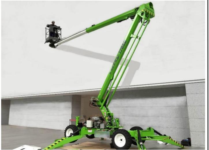
屈折ブーム、伸縮ブーム、バスケット首振り (SD210,nifty210)、旋回の各機能を使って最大限に目標物に接近する事が可能。最大作業可能高さ21.3m（最大床高さ19.3m）水平方向最大アウトリーチ12.8m（いずれもSD210）と、一度の設置で広範囲な作業領域をカバー
