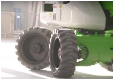
大型機ながら最小回転半径をHR28でも6m以下に 小回りが効くので狭い場所や室内ユースにも対応 ●写真はHR21E
