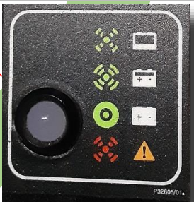
地上側操作盤には視覚的に判断のできるバッテリー充電インジケーターを装備
