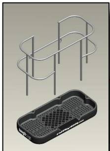
軽くて頑強な独自のタフゲージ(バスケット)で搭乗者を保護 (HR12N以外)
