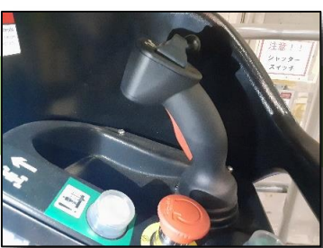
ジョイスティックの採用により、操作がより感覚的に (HR12N以外)
