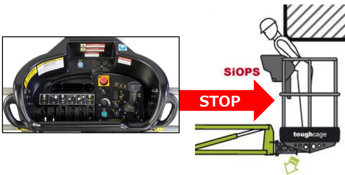
機能的に配置されたコクピット内の操作パネル(左図)とSIOPSの作動想定図(右図) ●HR12N以外の機種に採用
