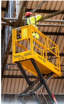
コンパクトなボディで最大作業床高さ5.77mのオプティウム8 最大作業床高さ8.15mのコンパクト10
