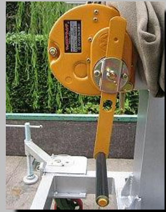
省力型のウインチでワイヤーを巻き上げます
